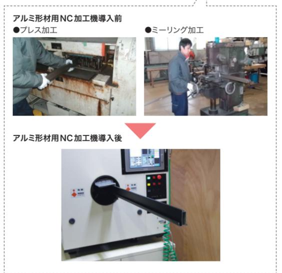
ミーリング加工は1カ所加工するたびに固定や目印をつけるけがき作業が必要で、複雑な形の切削を行うためには手間がかかり時間を要する。本設備は、加工したい形状のプログラムを呼び出し、アルミ型材を差し込んで稼働させれば、自動で切削加工を行うことができる。ミーリング加工で10分ほど時間を要する加工が、NC加工機では3分ほどで完了し、大幅な時間短縮となり、生産増が可能となった。
