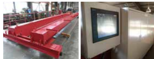
クレーン本体 クレーン制御盤 (設置前)
