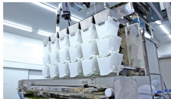
「カットねぎ」や「パックサラダ」のパッキング工程において、あらかじめ設定された重量のカットねぎやキャベツを自動充填するとともに、パックの表面・裏面へ同時に、指定したラベルシートを貼付できる。
