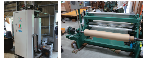
蒸気ボイラー スリッター
