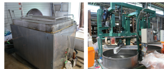
釜(中に原料カゴが設置されている) 打解機
