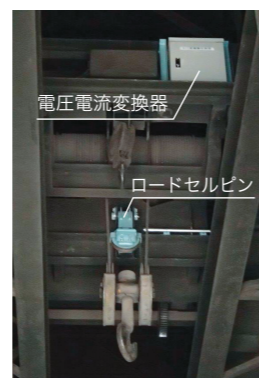
クレーンフック上のロードセル・ピン及び電圧電流変換器
