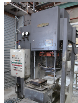
金型をセットするプレス機
