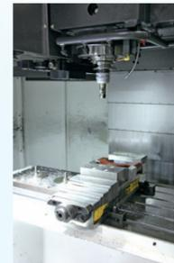
部品の加工には、複雑な形状のネジ穴加工が繰り返し出てくるが、本来、穴開け加工では素材の材質と加工部分の径に応じて適切な加工条件(周速)がある。仕上げ面の精度を上げるには径の大きさに応じた周速で加工することが望ましい。
