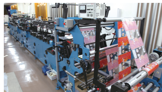
導入したセンタープレス式製袋機
