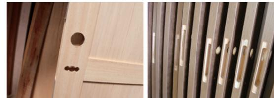
また、ニーズの高い窓開け加工は、正確さを要する下地加工、ハンドルタでの切り出し、ノミでの角四方面取り、ペーパー仕上げをすべて熟練工が手作業で行っており、作業効率が悪かった。本マシニングセンタを使用することによって、熟練の技術を要することなく高速で加工することができ、加工精度もアップした。
