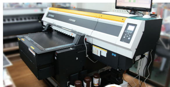
▲UVインクジェットプリンター 機種: Mimaki UJF-7151plus 最大印刷サイズ 710mm×510mm ※レーザーカットマシン最大切断サイズ 960mm×610mm
