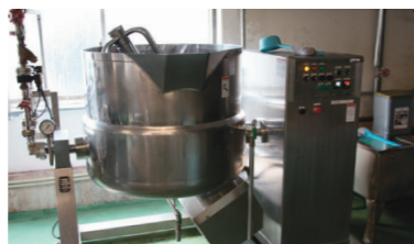
▲蒸気加熱ニーダー(一式) 外釜と内釜の間に蒸気を通すことによって中のおかずみそを加熱し、焦げないように自動で攪拌しながら殺菌する。
