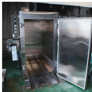
▲蒸気スチーマー(一式) 棚状のワゴンにビン詰め、袋詰めを行った製品を並べて入れ、加熱殺菌する。製品1つに温度センサーを挿しておく、殺菌に必要な温度・時間を自動で管理する。
