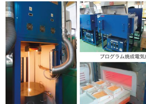
大型ガラス溶融炉 プログラム焼成電気炉
