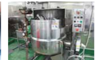
③ 温度センサー付き蒸気釜 ペースト状にした野菜と油、調味料を入れて攪拌しながら火入れを行う釜
