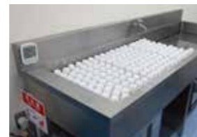
④ 水温管理冷却装置 0℃の水を循環させ、完成した65℃前後の製品を急速に冷やす装置
