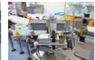
⑤ ラベルチェッカー 賞味期限やロットナンバーなど、ラベル情報に記載漏れがないかをチェックする装置
