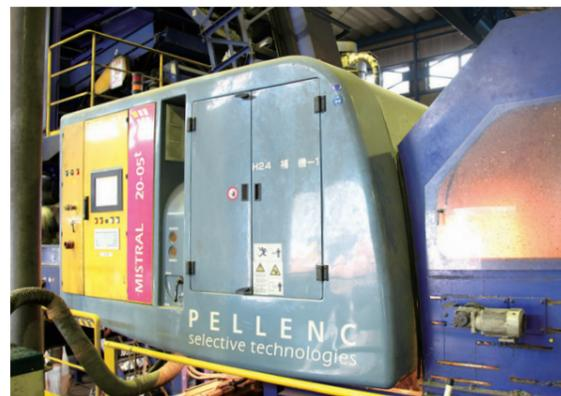
光学式選別機は、廃プラスチックを投入しセンサーを通して高速ベルトコンベアー、素材を判別するセンサー、素材毎に分別するためのアウトプットボックスの3つのパー
