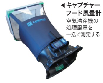
▲キャプチャーフード風量計 空気清浄機の処理風量を一括で測定する
